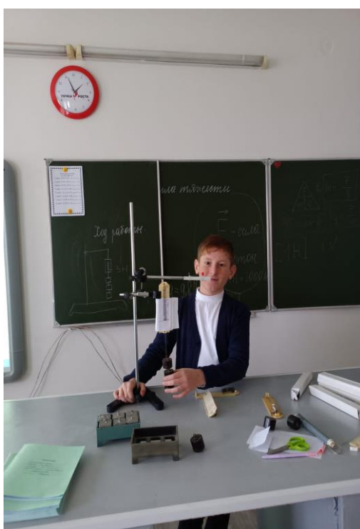
«Градирование пружины и измерение сил динамометром».
